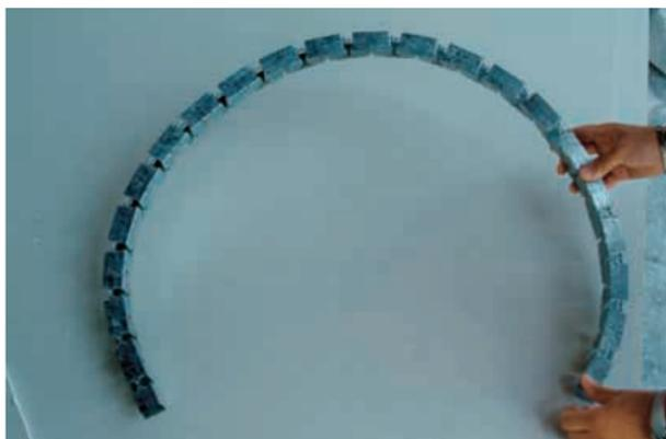
In tal modo, in tutta semplicità, si ottiene una guida curva in cui posizionare liberamente i profili montanti, per poi rivestire con le lastre in gesso rivestito.
