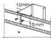
Viti storte, o non a filo con la lastra, devono essere rimosse e sostituite perché difetteranno nella tenuta. Le viti autofilettanti fosfatate da cartongesso sono a testa svasata per consentire una corretta penetrazione nella lastra in cui la vite non rompe il cartone, ma lo mantiene come base di appoggio continua della testa. Ciò consente un corretto funzionamento dell'ancoraggio.
