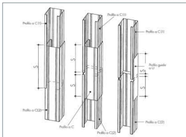
I profili giuntati devono essere solidarizzati con viti ogni 50/100 cm. Le giunzioni devono essere sfalsate. Le ali dei montanti a "C" hanno altezza differenziata, per permettere l'inserimento di un montante nell'altro a formare un **profilo scatolare**, ad elevata rigidezza meccanica (Foto 12).
