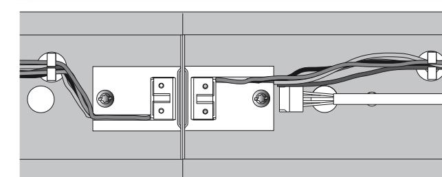
D Zur Vermeidung von EMV-Problemen darf die Durchgangsverdrahtung in Leuchten mit EVG nicht direkt parallel zu den Lampenleitungen verlegt werden. Vorgesehenen Leitungshalter verwenden. Funktionserdanschlüsse mit Erde verbinden. Leitung nicht am Vorschaltgerät vorbeiführen.
