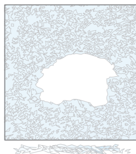
Tipo di frammentazione di un vetro temprato.
