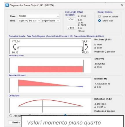
Nessuna delle tre sezioni viene verificata a presso-flessione, poiché il valore di  $\sigma_{max}$  è maggiore di  $f_{yd}$ .
