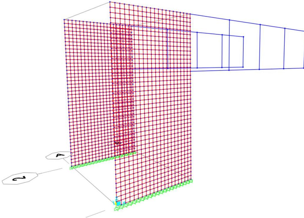
Definiamo la sezione dell'area: tipo (Shell-Thick); materiale (C28/35); spessore (1,2m).
