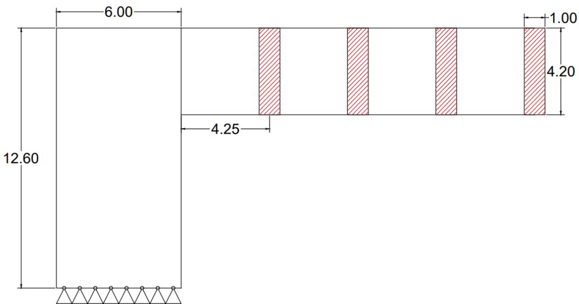
Dato che la trave Virendeel è assimilabile alla configurazione di un telaio di tipo Shear ruotato di  $90^\circ$ , possiamo delineare la deformata del nostro modello.
