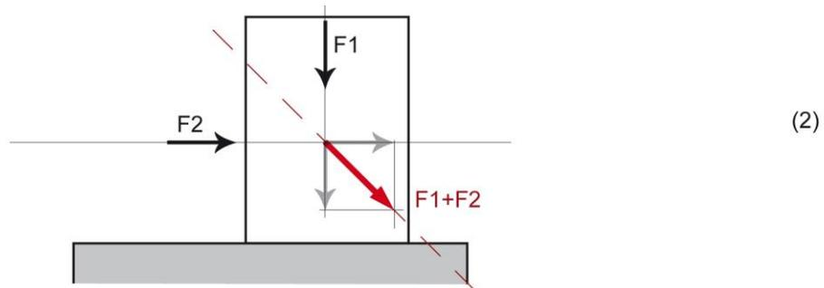
Ovviamente vale anche l'inverso: sia che riduca un sistema di due forze alla loro risultante, sia che si scomponga una forza nelle sue due componenti, il sistema rimane equivalente. Ad esempio:
