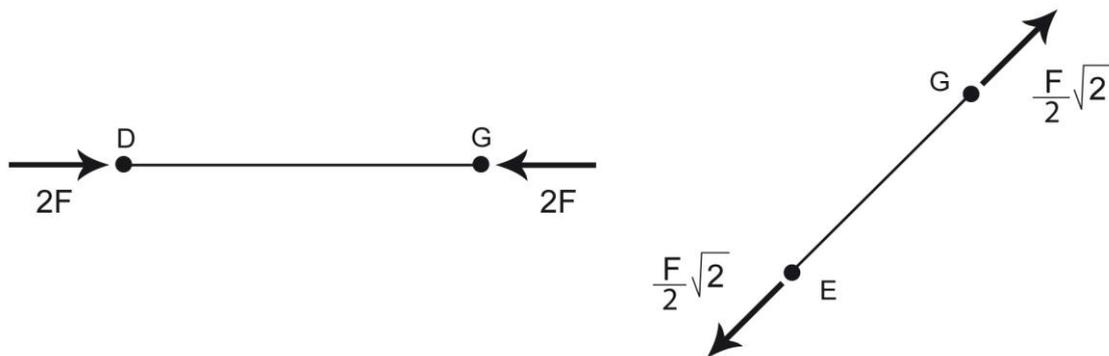
Andiamo a studiare lo stesso nodo tramite il metodo geometrico: questo metodo consiste nello scomporre tutte le forze che agiscono sul nodo tramite la regola del parallelogramma (sempre seguendo l'inclinazione delle aste della trave), una alla volta, e sommare quelli che risulteranno essere i contributi di diverse forze agenti lungo la stessa retta d'azione. Torniamo allora al nodo (B) rappresentato in figura (10), e ricordiamo che il risultato deve coincidere con quello appena ottenuto:
