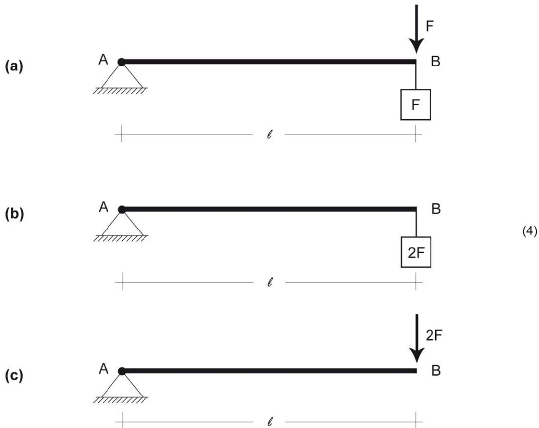
I tre sistemi di forze sono equivalenti (sforzate l'intuito). Ricordando la definizione di sistemi di forze equivalenti, i tre sistemi in figura lo sono perché hanno la stessa risultante ( $= 2F \hat{i}$ ) e lo stesso momento risultante rispetto al punto (A) ( $= 2Fl \hat{j}$ ). Questo esempio sancisce che si può traslare una forza lungo la sua retta d'azione senza alterare gli effetti meccanici sul corpo rigido.
