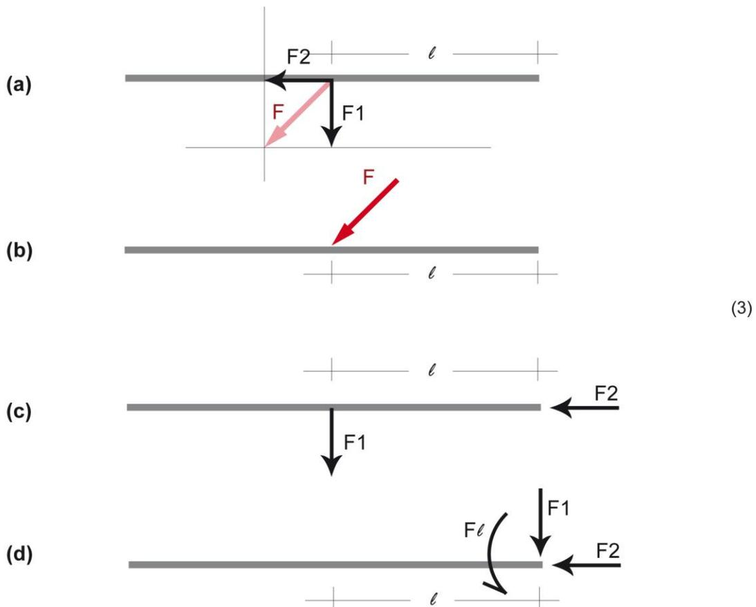
I sistemi di forze (a), (b), (c), e (d) di figura (3) sono tutti equivalenti. E' necessario ricordare che, se ho una forza e due direzioni, posso decomporre la forza lungo le due direzioni. Ma qualora le direzioni fossero tre, la forza non potrebbe essere scomposta ed il problema risulterebbe iperstatico.
