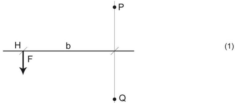
Nel caso in figura (1), posso calcolare i momenti della forza F rispetto ai due punti (Q) e (P), ricorrendo alla definizione vettoriale, e dimostrare che sono eguali:
