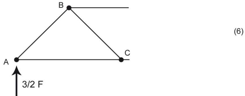
Ricordando che non modifico gli effetti meccanici se traslo una forza lungo la sua retta d'azione, posso ridisegnare il nodo come in figura (7), ed andarmi a costruire il parallelogramma con cui scomporre la forza (tenendo presente che le direzioni delle forze sono le direzioni delle aste, e che le aste sono inclinate a  $45^\circ$ , per cui ogni triangolo è un semiquadrato di lunghezza ( $2l$ ) ed altezza ( $h$ ) con  $l = h$ ):
