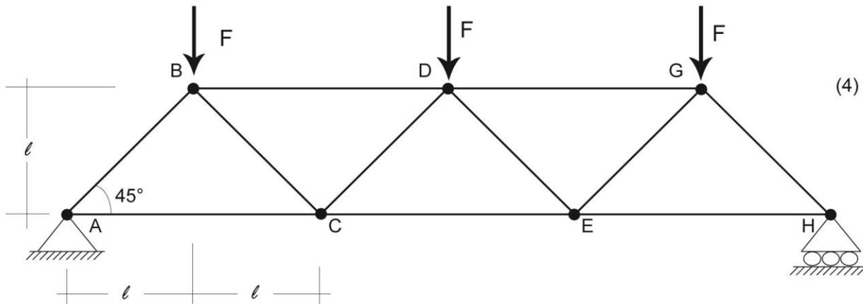
Anzitutto verifichiamo che la struttura sia isostatica: in un piano ogni corpo ha **tre gradi di libertà**, lo spostamento verticale, orizzontale, e la rotazione. Questo sistema è composto da 11 corpi, quindi 33 gradi di libertà. Perché la struttura sia isostatica devo avere gli stessi gradi di vincolo. Per calcolare il grado di vincolo di ogni asta utilizzo la seguente formula:
