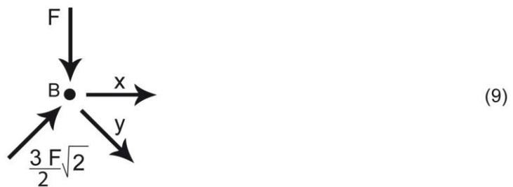
Per trovare i valori delle forze (x) ed (y) è possibile utilizzare due diverse metodologie di calcolo: l'**equilibrio al nodo**, oppure il **metodo geometrico**. Svolgiamo l'esercizio in entrambi i modi, tenendo in mente che ambedue i metodi devono portare allo stesso risultato; di conseguenza, utilizzare entrambe le procedure può essere anche uno strumento di verifica, poiché, qualora i risultati non coincidessero, sarebbe evidente la presenza di un precedente errore di calcolo.
