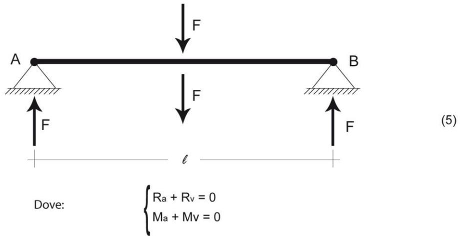
Quello che conta per il corpo rigido è quindi la risultante ed il momento risultante di un sistema di forze. Quindi è importante assimilare la nozione di equivalenza di un sistema di forze: **due sistemi sono equivalenti se hanno la stessa risultante e lo stesso momento risultante**. Ad esempio:
