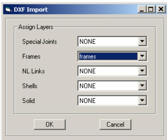
in cui dovete selezionare il nome del layer di AutoCAD in corrispondenza degli elementi "Frames". Date un "ok" e selezionate la vista nel piano XZ. Dovreste a questo punto vedere quanto riportato nella figura seguente
