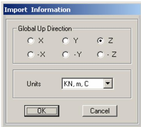
in cui selezionate "Z" come direzione globale verticale e come unità di misura kN,m. Date un "ok" e si apre la seguente figura
