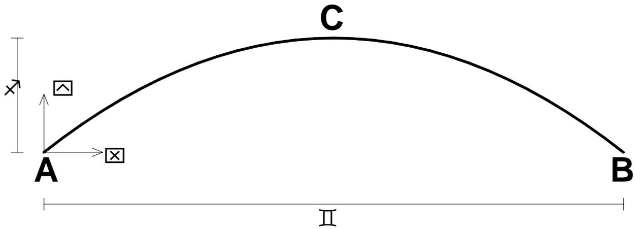
1) si parte dall'equazione analitica della parabola espressa in funzione delle caratteristiche geometriche (luce e freccia) dell'arco (vedi figura):
