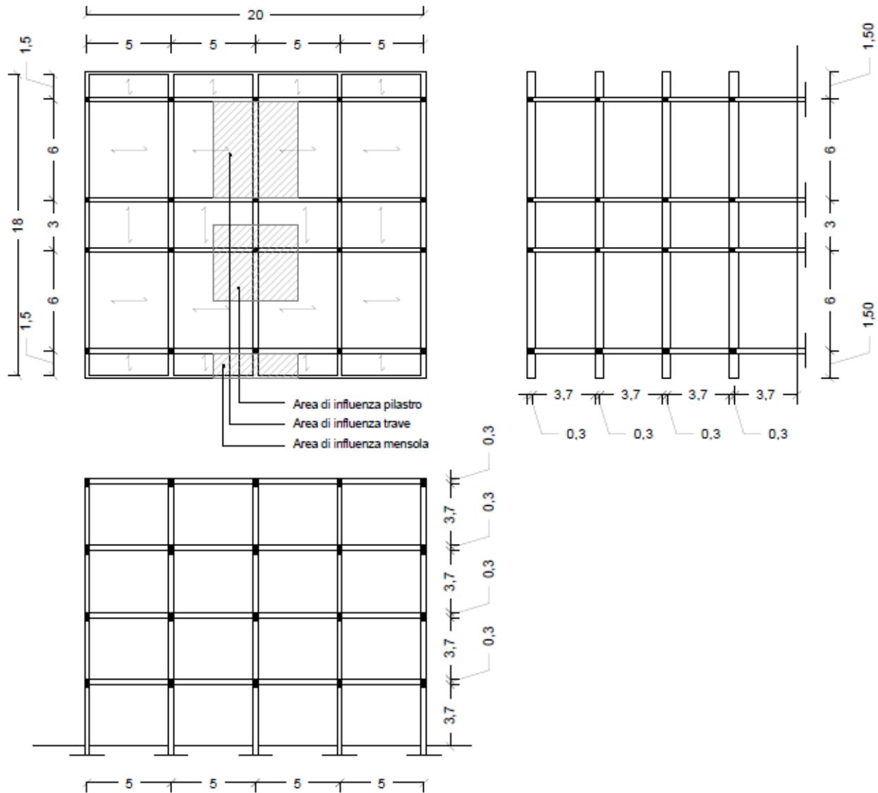
In primo luogo si procede con la scelta della tipologia tecnologica del solaio, in questo caso in laterocemento, e poi si effettua l'analisi dei carichi:
