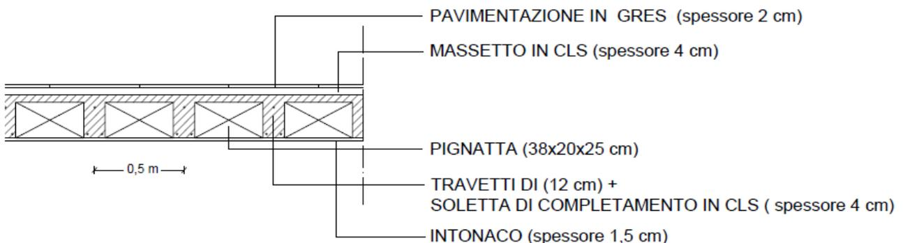
Gli elementi strutturali sono stati scelti per ottenere nel complesso una dimensioni pari ad 1/25 della luce.
