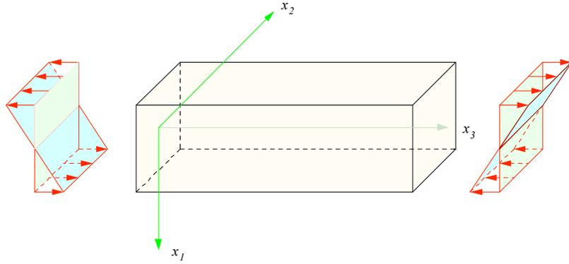
Figura 3: Rappresentazione dello stato di sforzo
