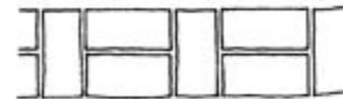
Fig. 36 - Concatenamento gotico (o polacco). Schema aggregativo, soluzioni d' angolo e di testata
