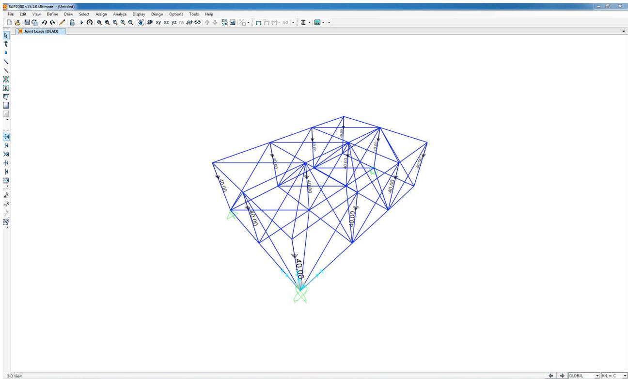
N.B. In questo tipo di esercizi, impostiamo l'analisi in modo che non consideri il peso proprio della struttura (che costituirebbe un carico distribuito su travi che si deve considerare scariche).
