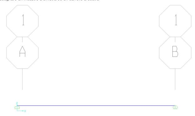
assegnare il carico uniformemente distribuito: selezionare l'asta > ASSIGN > FRAME LOADS > DISTRIBUTED > impostare l'unità di misura voluta (nel nostro caso N, m, °C) > nella casella UNIFORM scrivere (ad esempio) -10 KN
