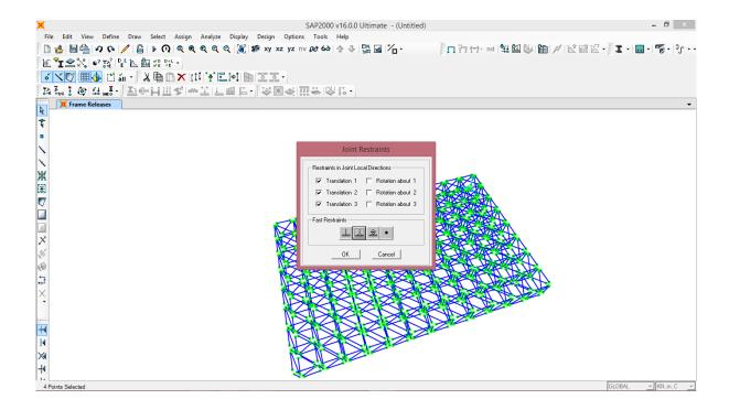
Una volta determinata la struttura si necessita di distribuire i carichi ai nodi e per farlo c'è bisogno di calcolare il peso proprio della struttura. Questo si ottiene assegnando il Load pattern DEAD e avviando l'analisi dell'intera struttura ottenendo le tabelle dei risultati (Join reaction) sommando fra loro le reazioni vincolari verticali di ogni appoggio presente.
