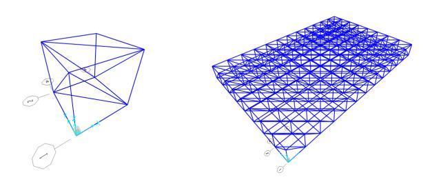
Si è quindi dato il comando "Release partial fixity" assegnando un rilascio nel momento a tutti i nodi in modo da ottenere delle cerniere interne ed assegnata una sezione Pipe section di default a tutti gli elementi della struttura.
