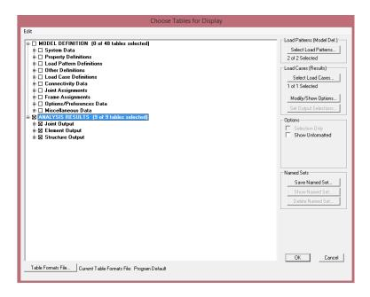
A questo punto si eliminano i dati non necessari al dimensionamento della struttura e delle aste compresse e tese.
