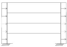
Per la facciata sopravento è stato moltiplicato 0,5 kN/m² per il coefficiente 0,8 ottenendo un valore di pressione pari a 0,4 kN/m², mentre per la facciata sottovento è stato moltiplicato 0,5 kN/m² per 0,4 ottenendo un valore di depressione pari a 0,2 kN/m².
