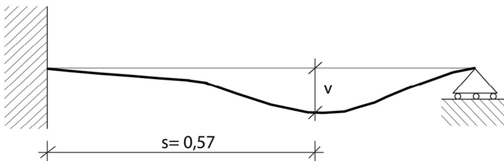
Ponendo  $q_2 = -q$  calcoliamo il momento e il taglio della struttura, i cui diagrammi saranno confrontati poi con quelli ottenuti dai calcoli con SAP come ulteriore prova della correttezza dei procedimenti svolti a mano.
