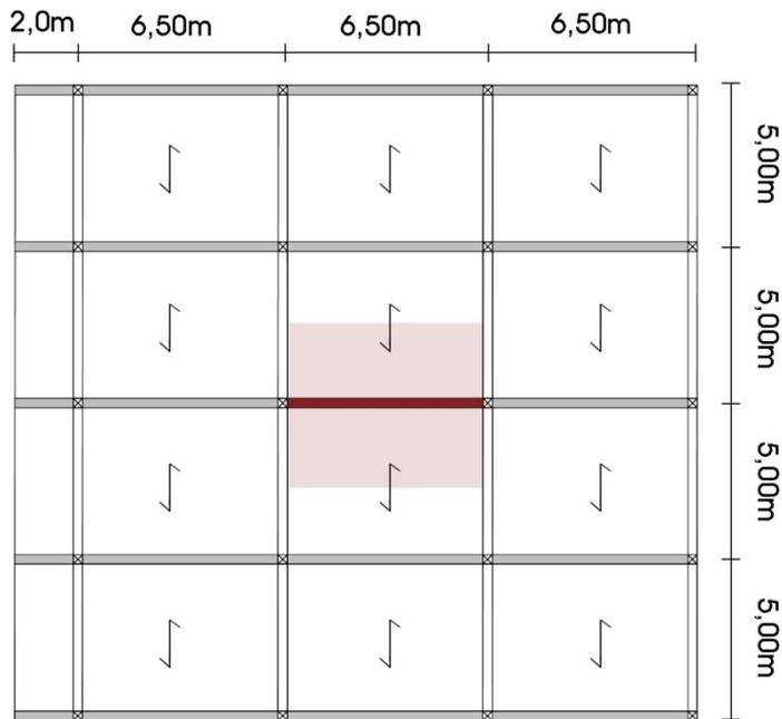
In questa esercitazione sono stati dimensionati la trave ed il pilastro maggiormente sollecitati all'interno di un telaio piano in tre diversi materiali: acciaio, legno e cemento armato. Ho scelto un unico telaio per tutte e tre le differenti tecnologie.
