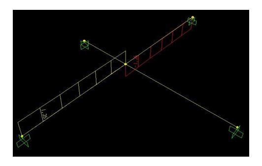
Ad una delle due travi, quella con la forza applicata ad un terzo della luce, è stata associata una sezione costante in acciaio di tipo scatolare, con spessori ridotti in modo da consentire abbassamenti sensibili che mettessero in evidenza il contributo dell'altra trave. Inoltre, così facendo essa mantiene costante la sua rigidezza flessionale, quindi le differenze nei valori delle rotazioni finali tra i diversi casi studio saranno dovute soltanto al contributo della rigidezza torsionale.
