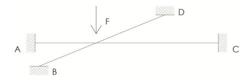
Il nodo ha 6 gradi di libertà: esso può avere 3 differenti traslazioni, secondo i 3 assi x, y e z; inoltre, può essere soggetto a rotazioni intorno ai 3 assi. In questo caso specifico, però, la condizione di carico non genera traslazioni lungo x e lungo y, così come non vi sono rotazioni in x e in z. Le incognite, dunque, sono soltanto due, ossia lo **spostamento**  $\delta_z$  e la **rotazione**  $\varphi_v$ .
