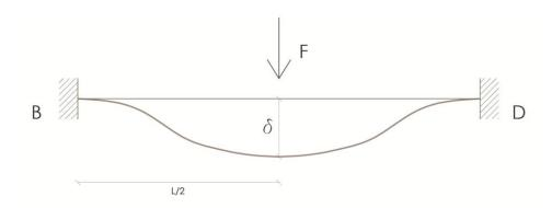
anche nell'asta BD soggetta alla sola traslazione il nodo si abbassa senza ruotare, quindi analogamente a quanto fatto in precedenza procediamo rapidamente al calcolo degli sforzi di Taglio e Momento Flettente, i quali per via della simmetria dello schema stavolta saranno identici:
