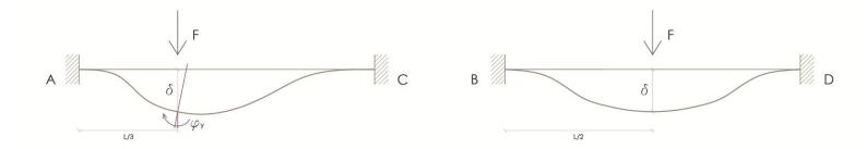
Sulla trave BD la forza F agisce esattamente al centro, quindi la deformata è simmetrica e in quel punto abbiamo uno spostamento  $\delta$ , ma nessuna rotazione della sezione essendo un punto di tangenza orizzontale. Sulla trave AC, invece, F agisce ad un terzo della lunghezza e, sebbene il punto trasli della stessa quantità lungo z, stavolta non ci troviamo nel punto a tangenza orizzontale della deformata, quindi avremo anche una rotazione della sezione intorno all'asse y.
